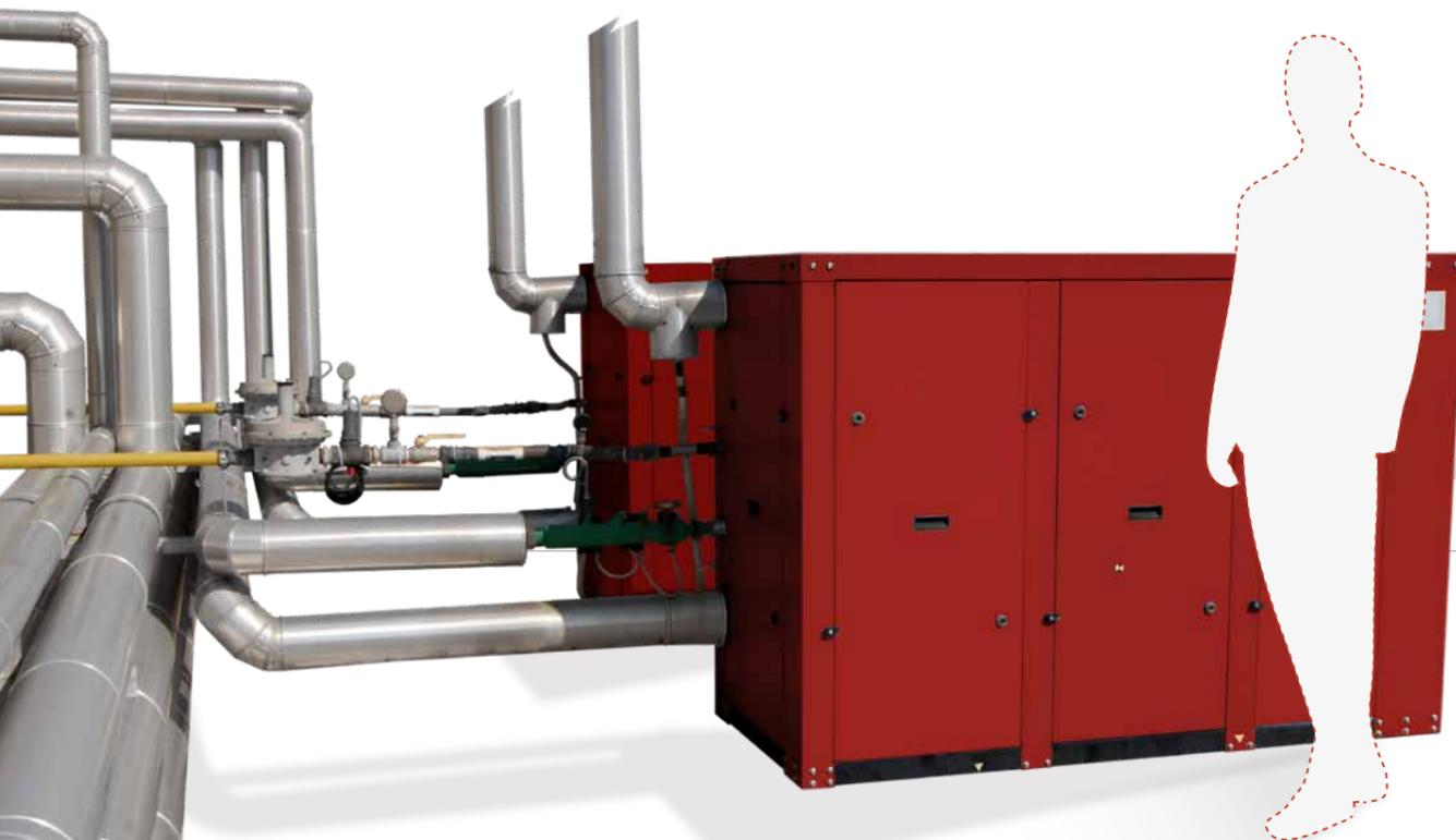
Il microgeneratore TOTEM CHP produce elettricità quando vi è una concomitante richiesta di energia termica. L'installazione di un accumulatore termico (puffer), dimensionato in base alla potenza del microgeneratore, permette al sistema di accumulare energia termica anche quando non vi è richiesta, per aumentare l'inerzia del sistema.
